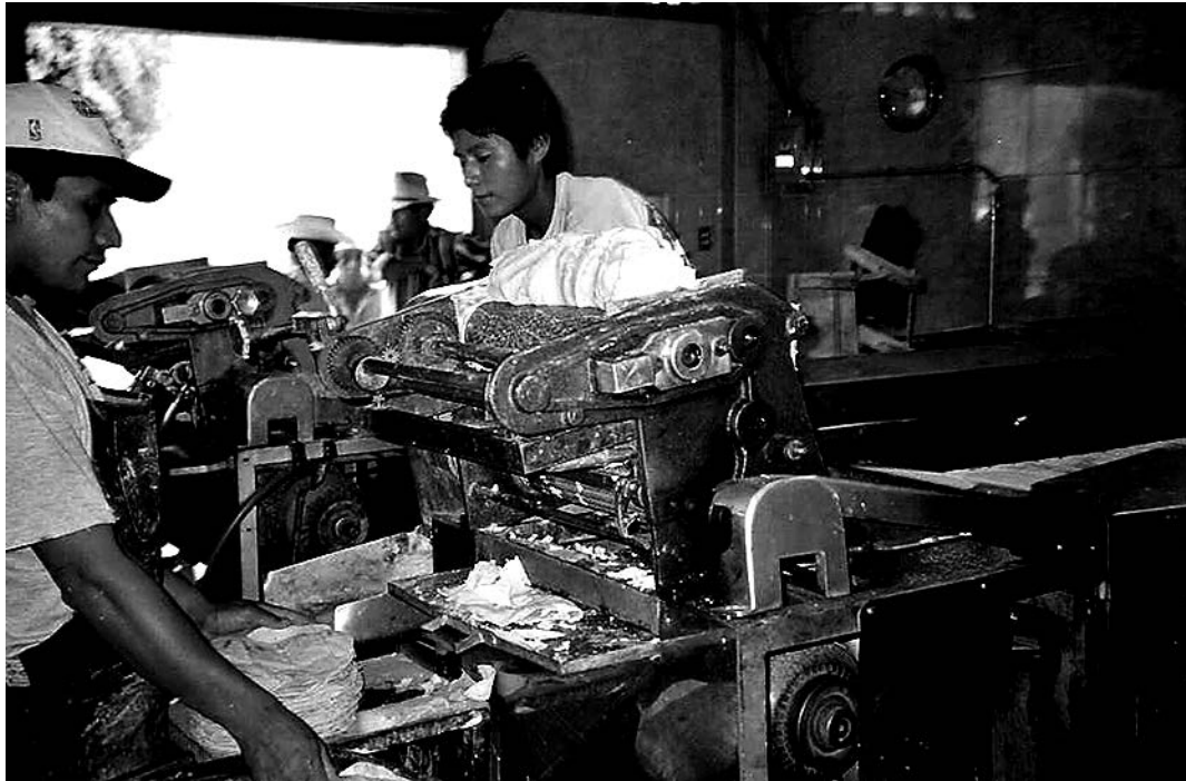
Màquina per fer "tortillas" a Mèxic
