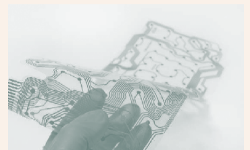
Paper transparent usat com a substrat electrònic, exemple d'electrònica flexible
